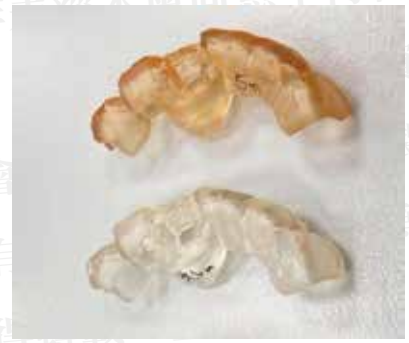
圖十三. 物件過度固化導致物件變色
