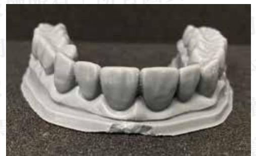
圖十. 不當力道造成物件損毀
